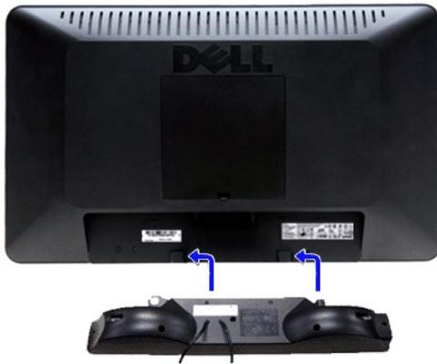
1. Von der Monitorrückseite aus befestigen Sie die Soundbar, indem Sie zunächst die beiden Schlitze mit den Zapfen an der unteren Monitorrückseite ausrichten.
